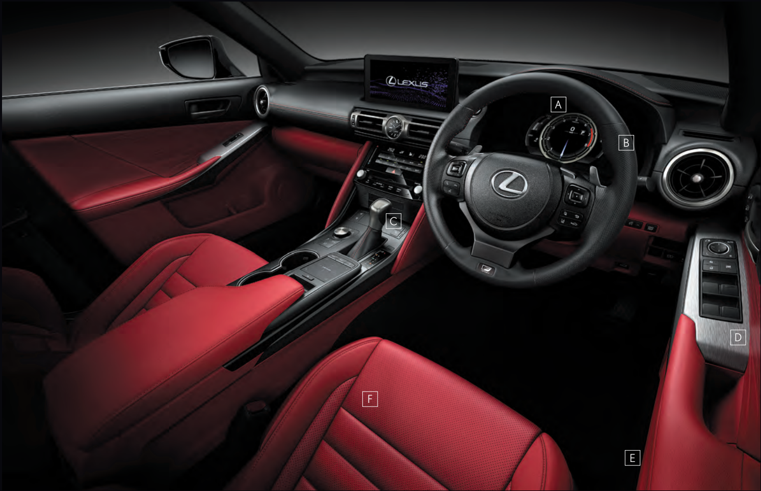
A_Single dial meter / B_Steering wheel / C_Shift lever knob / D_Trim / E_Scuff plates / F_Front seats A หน้าปัดแบบวงเดียว / B พวงมาลัยแบบ F SPORT / C หัวเกียร์แบบสปอร์ต / D พิวสัฟฟัลแบบสปอร์ต / E ทาบนันโด / F เบาะคู่หน้า
