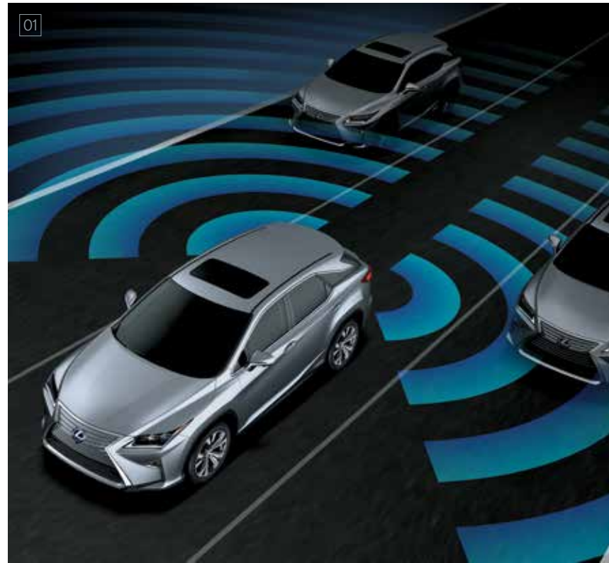
01 / Hệ thống cảnh báo điểm mù (BSM) Radar với bước sóng milimet ở cản sau phát hiện các phương tiện trong làn đường liền kề mà không nhìn thấy ở gương cửa. Hệ thống sẽ phát tín hiệu cảnh báo ở gương cửa cùng phía ngay khi phương tiện đi vào điểm mù.
